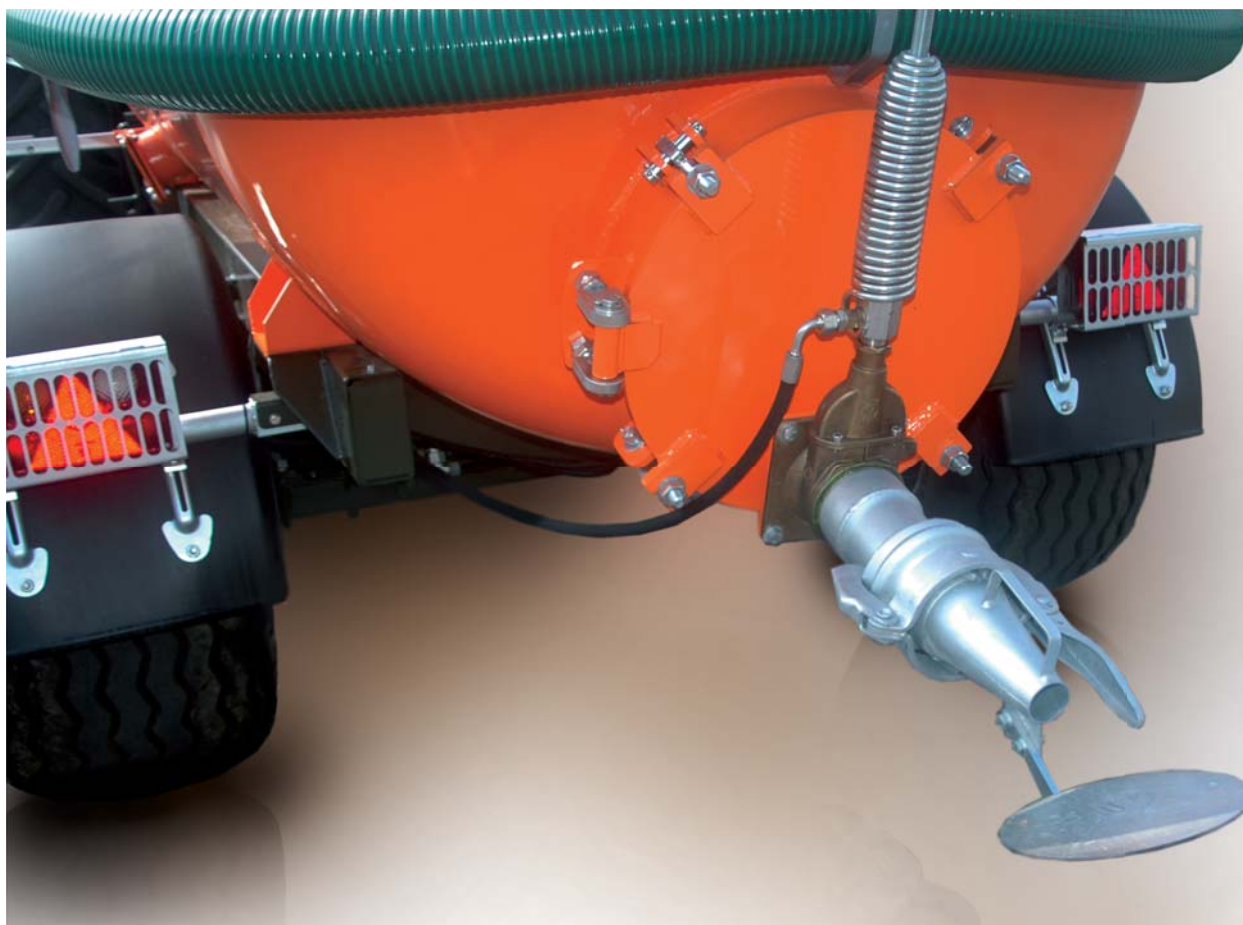
Z tyłu zbiornika zamontowana jest sterowana hydraulicznie zasuwą
