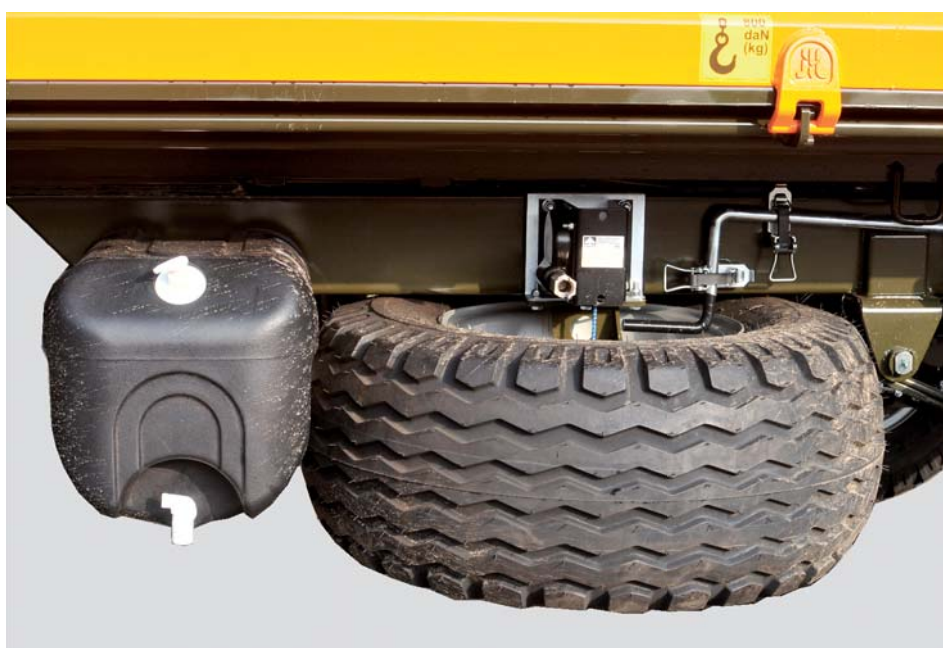
Wyposażenie dodatkowe przyczepy PT606: koło zapasowe wraz z wciągarką montowane w ramie podwozia. Obok zbiornik na wodę z pojemnikiem na mydło w płynie
