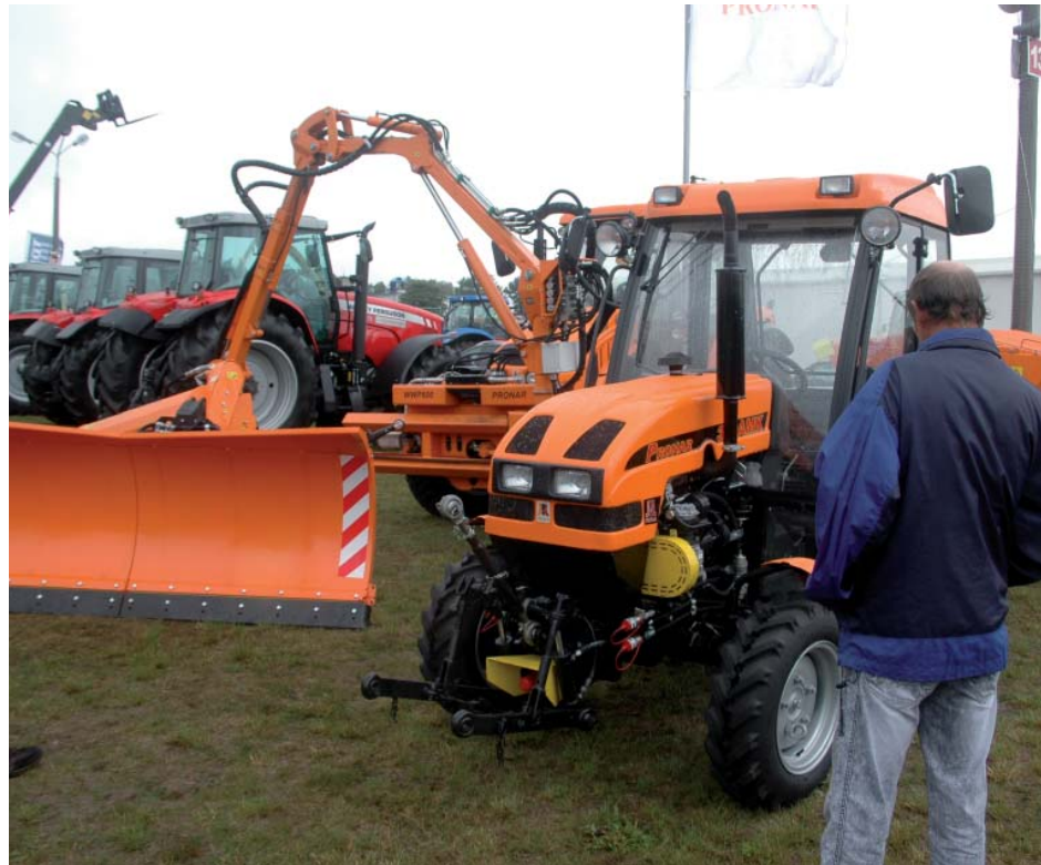
Ciągnik w wersji komunalnej PRONAR 5135K z podczepionym wysięgnikiem uniwersalnym WWP600 oraz ciągnik PRONAR 320AMK z posypywarką soli i piasku T130 na stoisku Agroma Sępólno Krajeńskie
