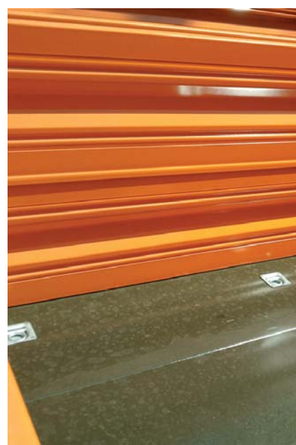
Uchwyty ładunkowe (8 sztuk) w przyczepie PRONAR o nośności 800 kg każdy
