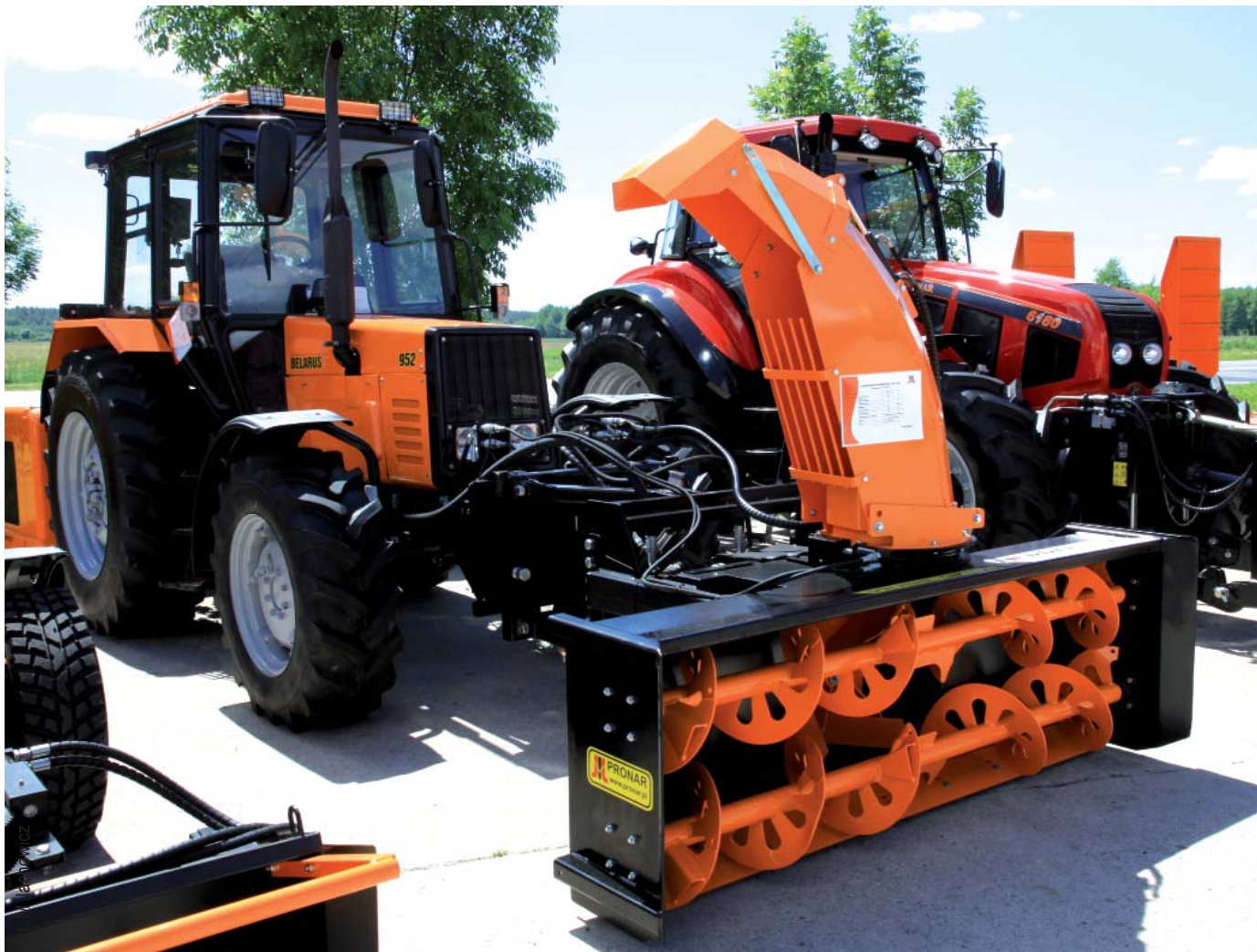
Odśnieźarka wirnikowa PRONAR OW 2.4H (napędzana zasilaczem hydraulicznym ZHD170)
