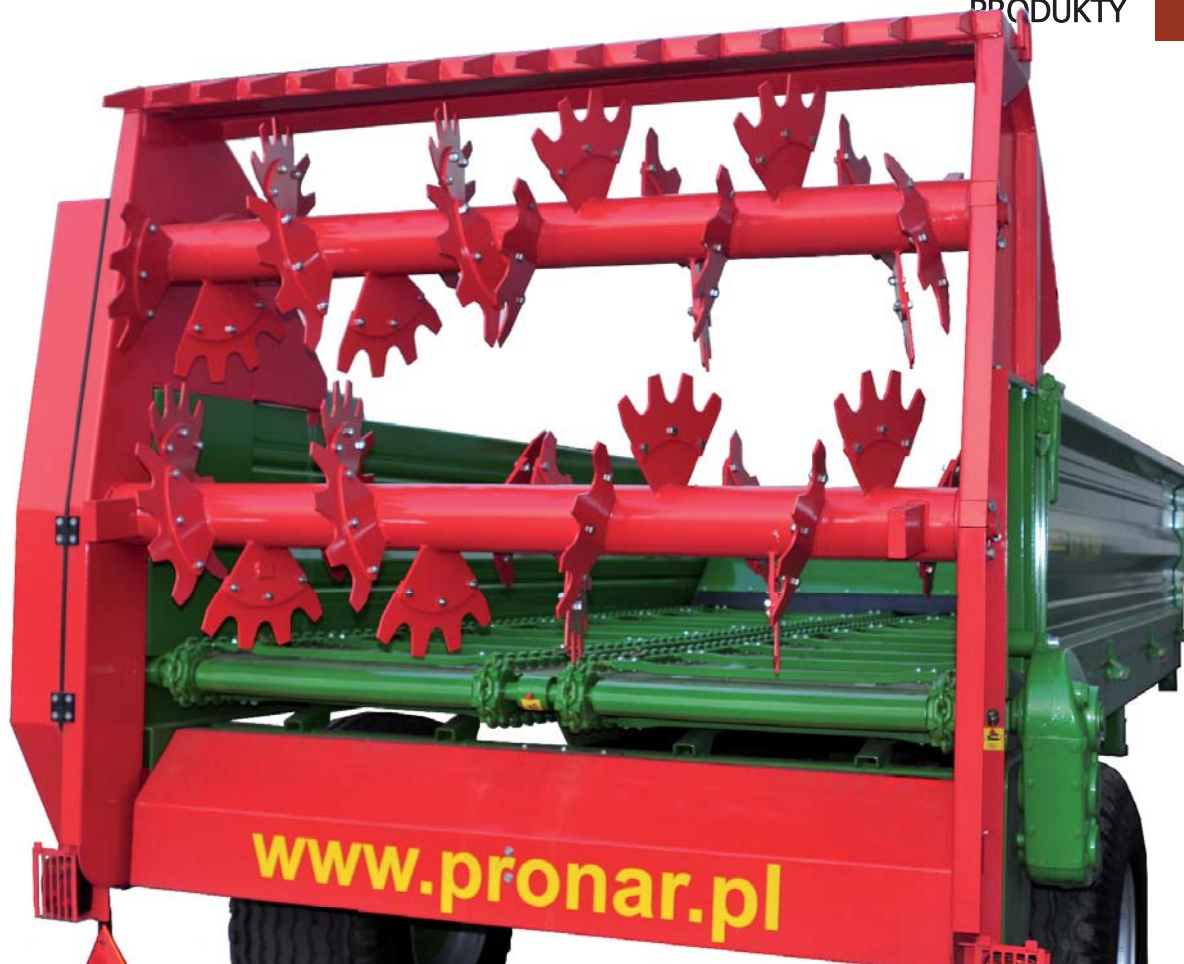
Rozrzutnik N161 wyposażony jest w adapter poziomy dwubębnowy z przykręcanyimi łopatkami
